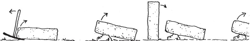
DER STEIN WIRD ANGEHOBE (KREUZPICKEL ODER HEBEISEN) UND MIT EINEM BROCKEN UNTERSCHLAGEN; DANN HOCHGESTELLT (WAS ANGEHOBE VIEL LEICHTER GEHT ALS LIEGEND), DANN LEST MAN DEN BROCKEN SO VOR DEN STEIN, DASS ER, NACH DEM DRÜBERFALLEN IN ANGEHOBE NEM ZUSTAND LIEGT, WORAUF SICH DER VORGANG WIEDERHOLT, BIS MAN AM ZIEL IST. DAS GEHT BEI EINIGER ÜBUNG ZIEMLICH RASCH.
